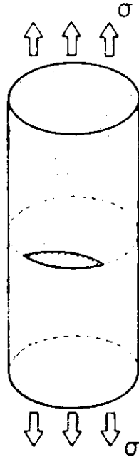
Fig. 1.- Alambre con una fisura superficial
