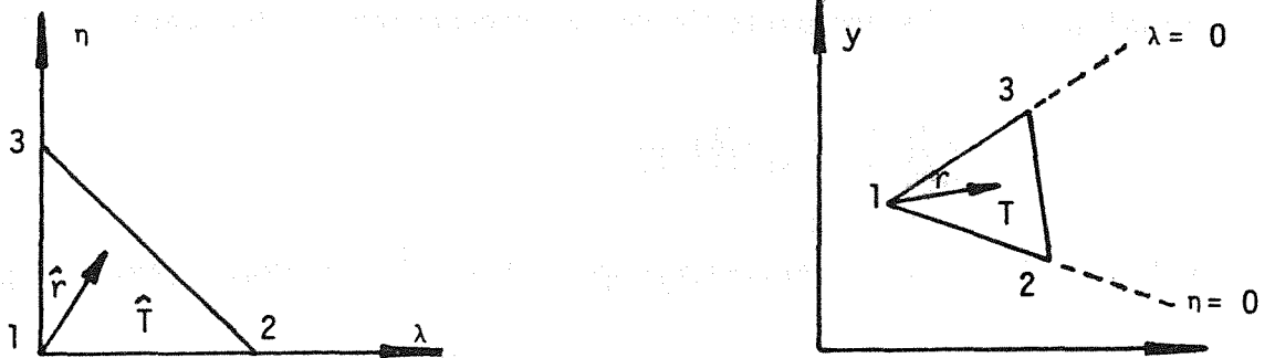
Fig. 5. Elemento triangular de tres nodos (Akin).
