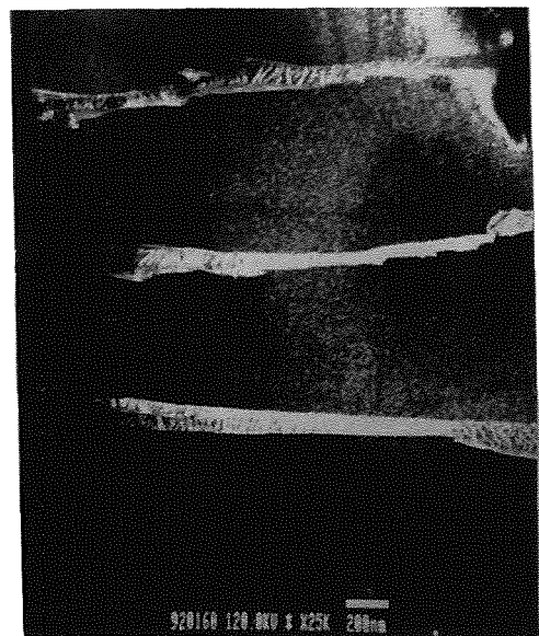
Fig.9. Placas de Widmanstatten sin deformar. Campo oscuro.
