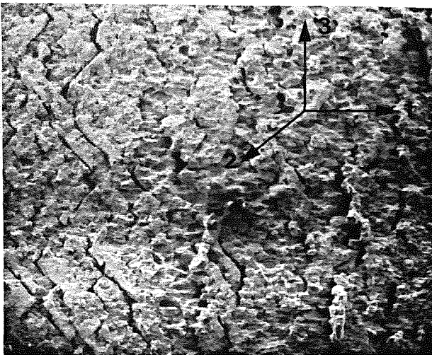
Fig. 8. Grietas sobre la superficie adherida al Incoloy 825 tras el despegue de materiales. Tratamiento térmico BT (SEM). 30X
