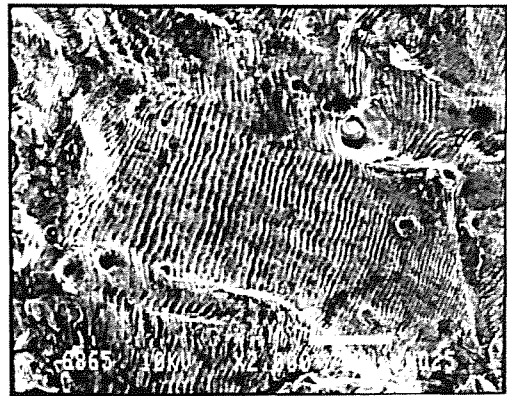
Fig. 10. Estriaciones dúctiles de fatiga en una zona intermedia de la rotura (SEM x 2000).
