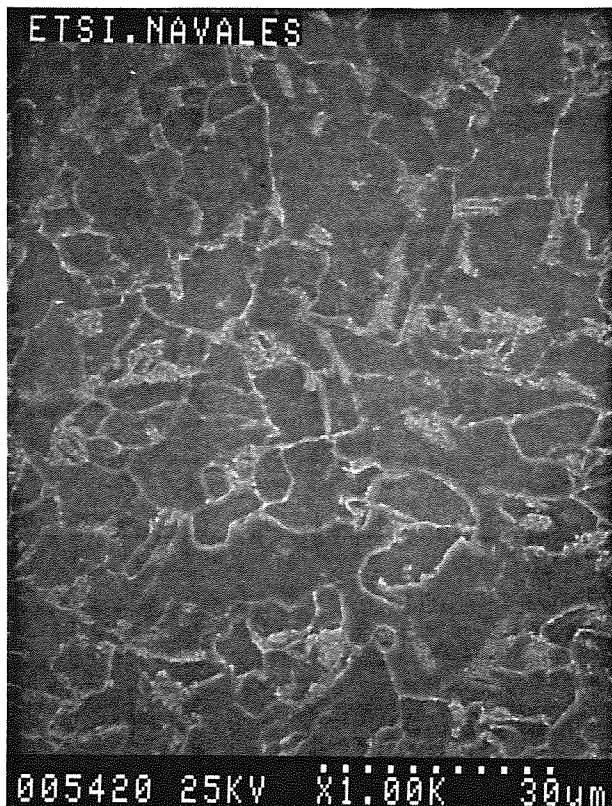
Figura 8. Tamaño de grano en el material base.
