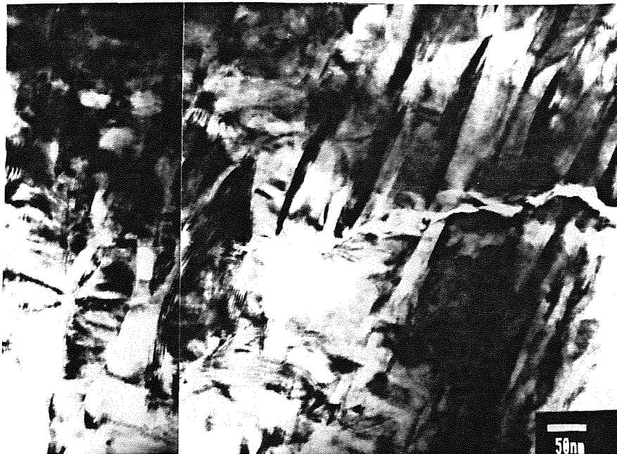
Fig. 5. Interacción grieta-precipitados en el material AR y la correspondiente transformación t-m de estos últimos.
