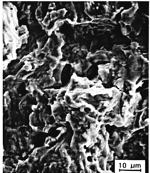
Fig. 4. Superficie de fractura con presencia de cavidades dúctiles nucleadas en inclusiones de MnS (acero microaleado al Ti-V, R = 0.5 , \Delta K = 27 MPa \sqrt{m} ).
