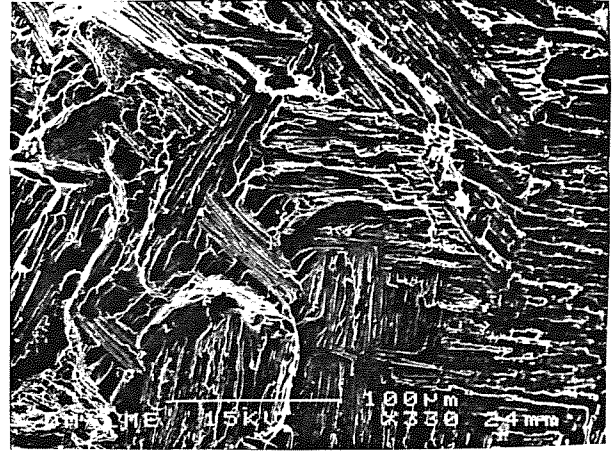
Fig.8. Superficie de fractura de la estructura de placas de Widmanstätten ensayada en medio fisiológico.
