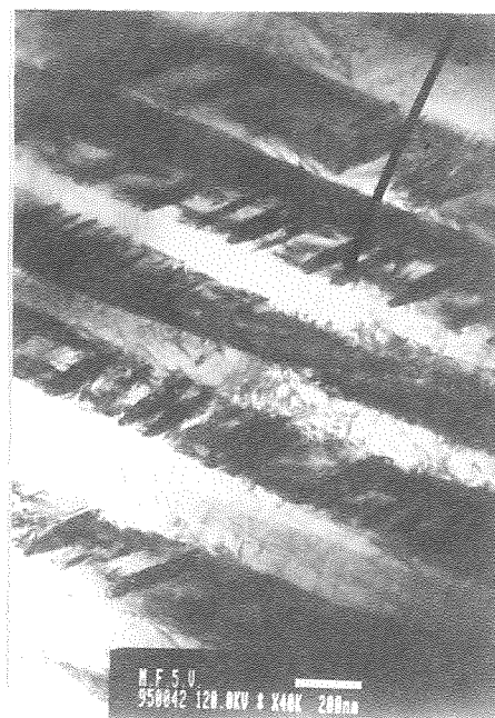
Fig. 8. Martensita \alpha' inducida por tensión para una muestra fatigada a 0.15 N_f . Eje de zona [5\bar{1}43] .
