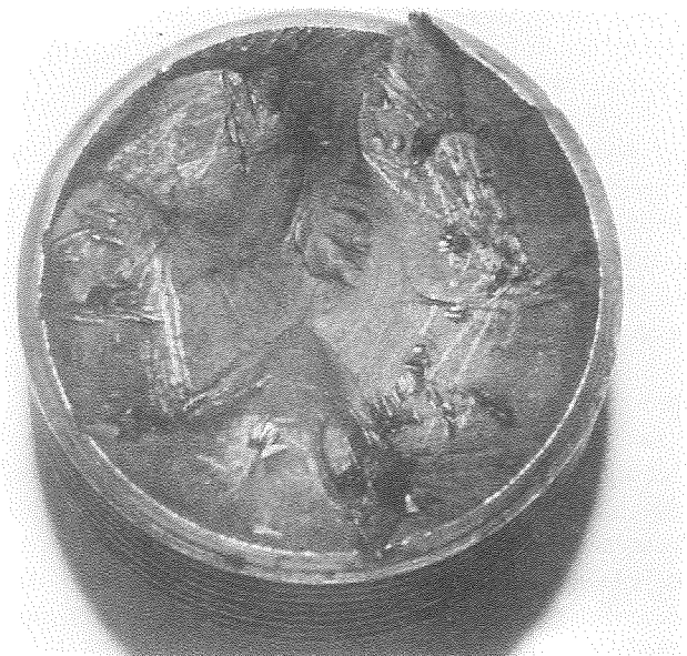
Fig. 9. Perno nº 3. Superficie de fractura en la parte central de la zona roscada. Fractura en "carraca" con sus características marcas radiales.
