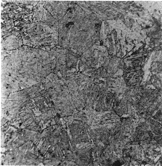
Fig. 6- Fotomicrografia do aço G (GC ZAT). Input térmico 3.5 KJ/mm. Mesmo para o mais baixo valor do input térmico a microestrutura apresenta-se claramente formada por microconstituintes duros resultantes de arrefecimento rápido no interior do grão perfeitamente identificado de austenite prévia.
