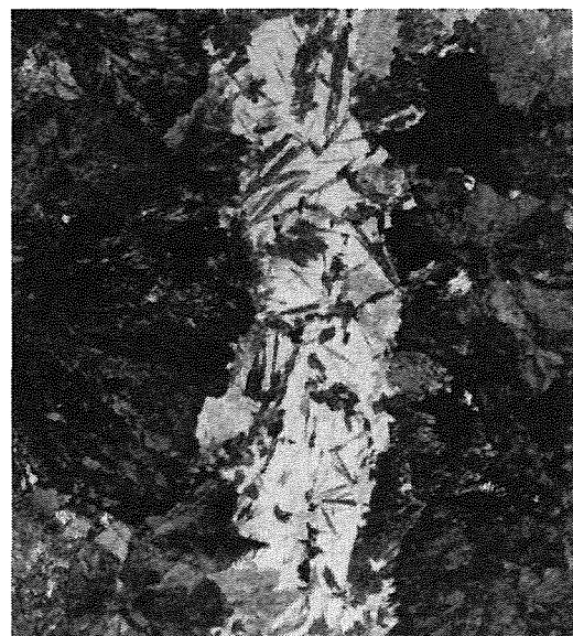
Fig.2. Microestructura del alma del carril N°3
