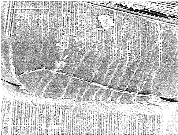
Fig. 6. Fenómeno de ponte de fibras, con derivación de la fisura, en el laminado 631 Q.
