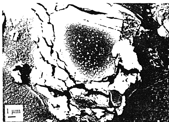
Fig. 10. Progresión de la grieta a través de la interfase generada por reacción entre el SiC y la matriz de aluminio.
