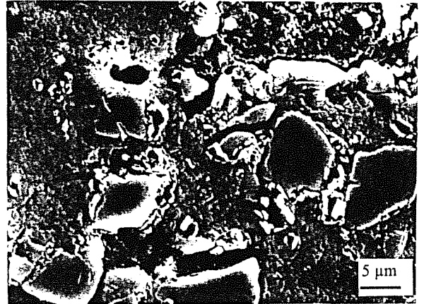
Fig. 5. Detalle de la nucleación de un poro en la interfase partícula-matriz
