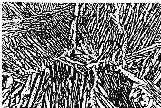
Figura 1. Microestructura de Widmanstätten
