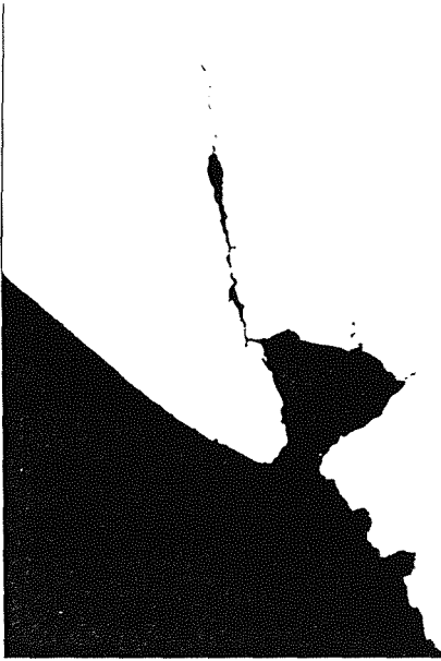
Fig.7. Preparación metalográfica del vástago de la figura 6. 100x, sin ataque. Picadura en la zona más deteriorada de la superficie de asiento.
