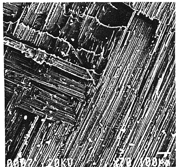
Fig. 8. Cambios del plano de deslaminación en la serie [0//90]uc
