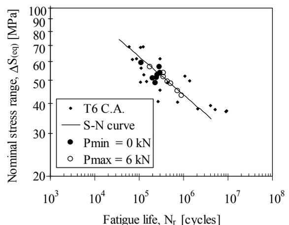
**Fig. 9.** Bloc variable amplitude fatigue results.
