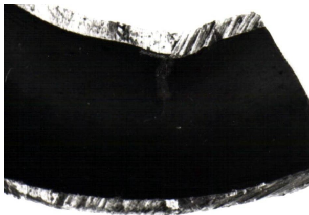
Figura 1. Sección longitudinal del pliegue 2A. Pliegue fisurado en la parte interna del codo. 2,4 X
