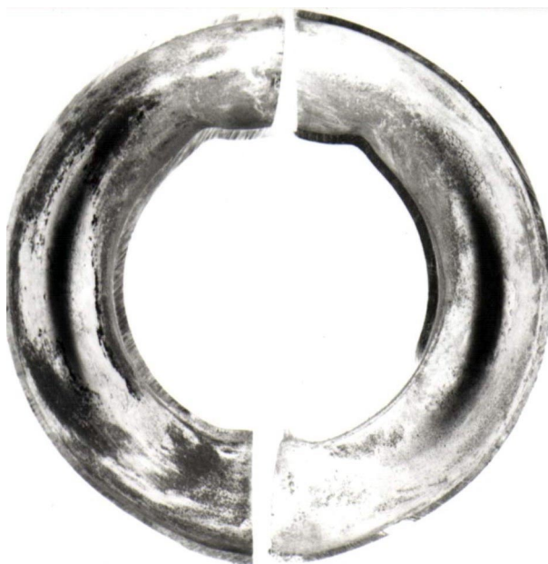
Figura 2. Codo 2B seccionado longitudinalmente. Pliegue en su parte interna. 0,9 X
