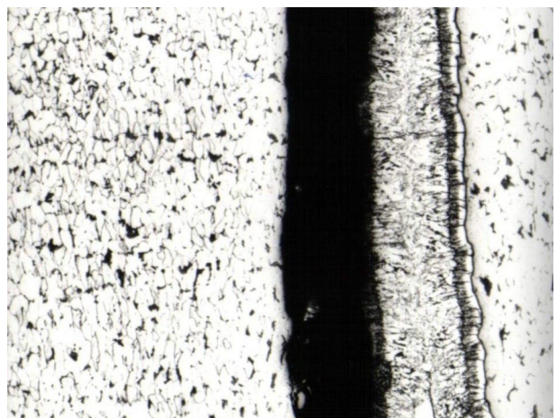
Figura 8. Detalle 2 de la figura 5. Grieta rellena de cinc. Deformación plástica del acero del tubo en las proximidades de la superficie exterior: granos de ferrita alargados. Ataque nital 2%. 100 X.
