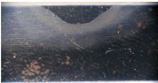
Fig. 9. Soldadura frágil en probeta Charpy modificada.
