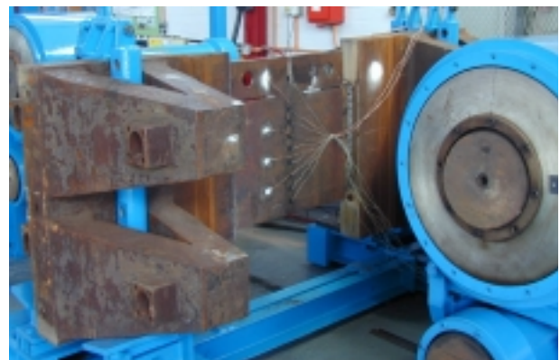
Fig. 1. Montaje del ensayo Doble Tracción.
