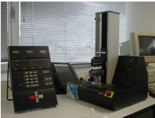
Figura 6. Dispositivo empleado para la realización de los ensayos de flexión en 4 puntos en una máquina Instron Mini 44. Obsérvese la bola bajo el junque inferior para asegurar un reparto simétrico de la carga aplicada.
