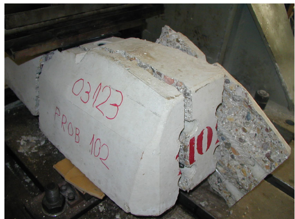
Fig. 8. Fotografía de la sección bajo carril de la traviesa 112 tras el ensayo con variación de la carga escalonada en ancho Renfe.
