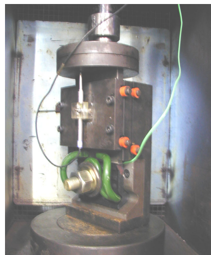
Fig. 2. Utillaje empleado para el ensayo de la placa.
