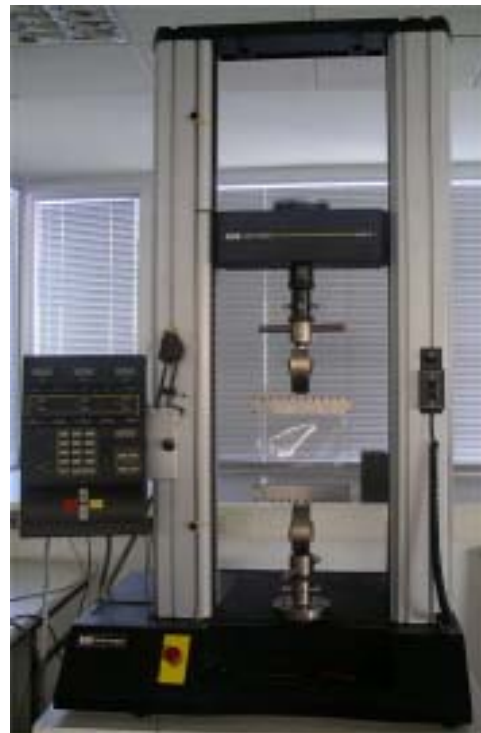
Fig. 1. Dispositivo experimental empleado para la realización de los ensayos de tracción de las transparencias.
