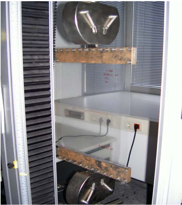
Fig. 2. Detalle de los útiles empleados para fijar las láminas de transparencias por sus extremos superior e inferior. Se observa cómo se montan sobre una garras de cuña que se emplean normalmente para la realización de ensayos de tracción.
