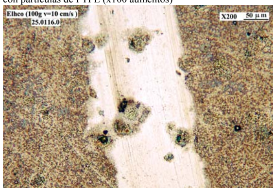
Fig.6: Micrografía óptica realizada sobre la huella en el disco recubierto de níquel químico con partículas de PTFE (x200 aumentos)
