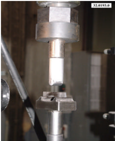
Fig. 1. Probeta de doblado en tres puntos montada en el dispositivo de ensayo.
