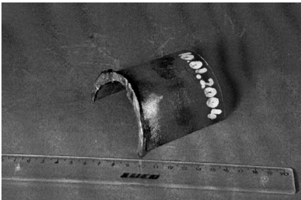
Fig. 3. Sección de la tercera rotura
