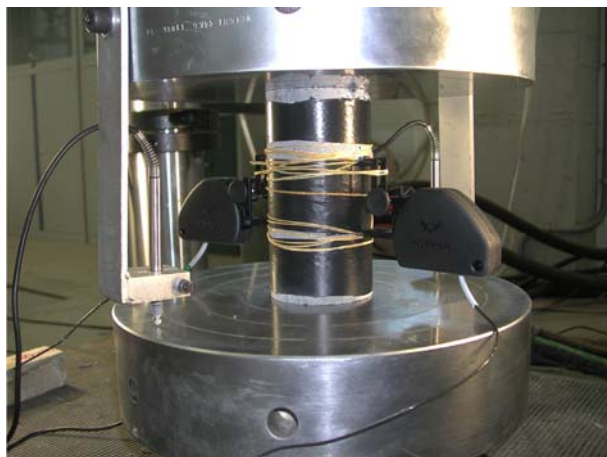
Fig. 1. Probeta C3 con los dos extensómetros tipo clip 2630 montados para medir la deformación hasta rotura y los dos LVDTs utilizados para controlar el ensayo y medir la deformación media.
