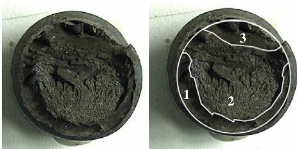
Fig. 7. Macros de la superficie de rotura
