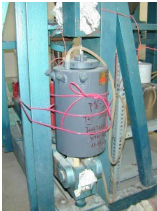
Fig.1.- Ensayo FIP de corrosión bajo tensión.
