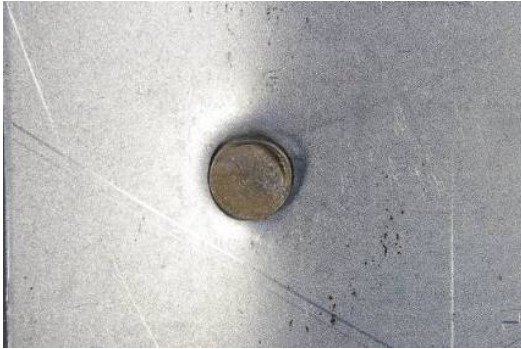
Figura 19. Modo de fallo de la unión piercing
