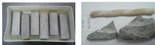
Figura 1. Probetas de mortero con barra embebida
