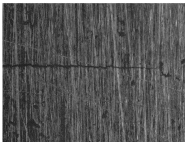
Figura 7. Imagen del avance de la grieta por carga estática en un instante t
