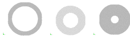
Figura 5 - Geometrías de la corona circular para diferentes diámetros de perforación (3 cm, 2 cm y 1 cm de izquierda a derecha).
