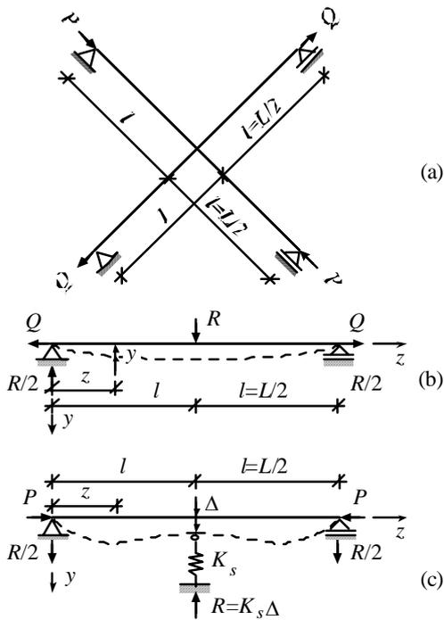
Figure 1. X-Bracing System.
