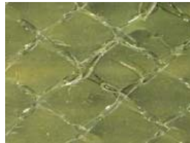
Figura 6. Adhesivo con soporte de tejido de poliéster.
