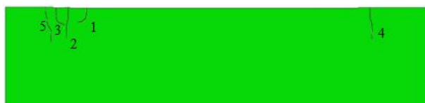
Figura 8. Patrones de fisuración en la base 8mx2m empotrada, 1, 2, 3, 4 y 5 corresponden a las fisuras para arreglos 1, 2, 3, 4 y 5 respectivamente
