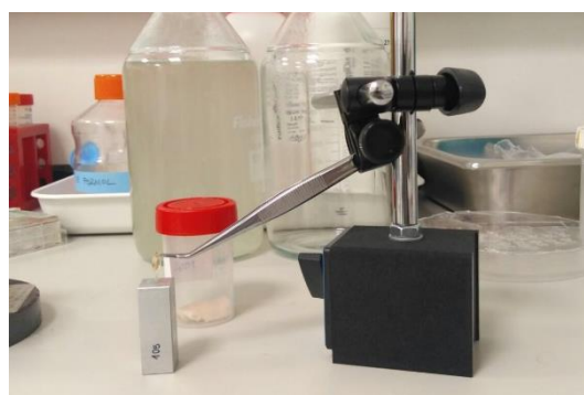
Figura 2. Sistema empleado para mantener la alineación del hueso durante el curado del adhesivo.
