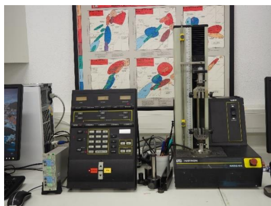
Figura 3. Equipo empleado para determinar la carga a rotura del hueso.
