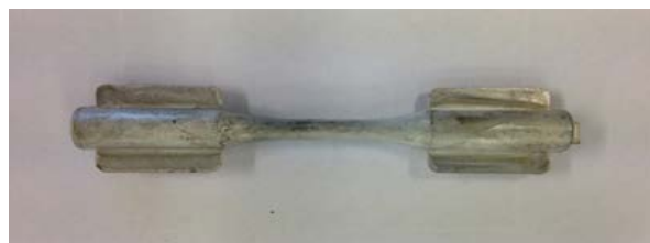
Figura 2. Muestras para los ensayos de creep uniaxiales.
