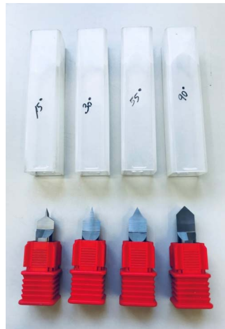
Figura 2. Herramientas de cortes fabricadas en metal duro mediante CNC.
