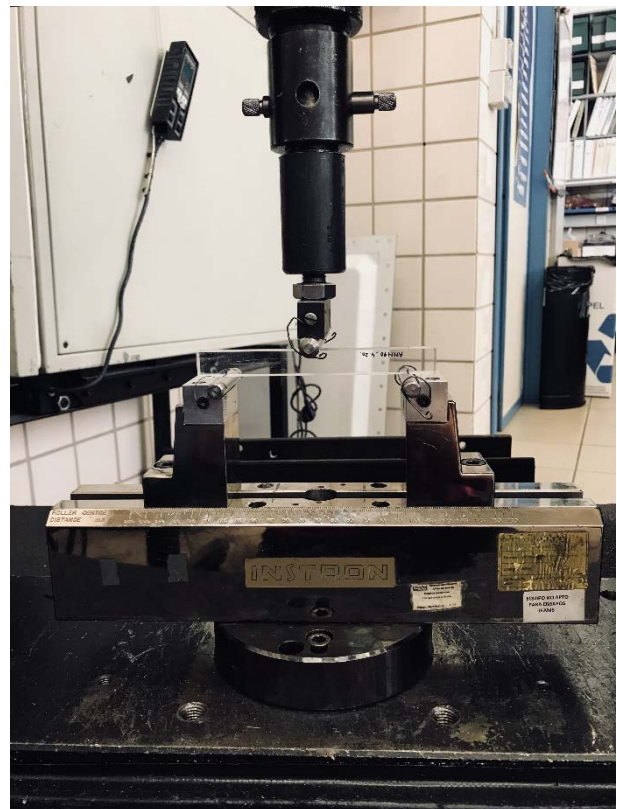
Figura 5. Máquina de ensayo INSTRON 4482 con el útil y la probeta para el ensayo tipo TPB.
