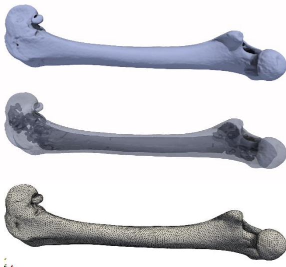
Figura 4. Geometría del hueso original extraída mediante 3DSlicer 4.11 Como una superficie (arriba), con una opacidad del 40% (medio) y la malla empleada para el cálculo por elementos finitos.
