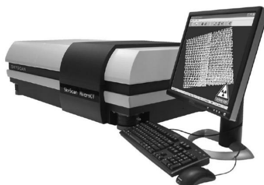
Figura 1. Equipo de micro-tomografía computarizada SkyScan 1172 empleado para caracterizar la geometría del hueso ensayado.
