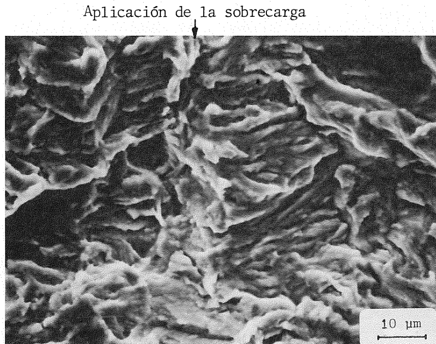
Fig.9 Superficie de fractura en el entorno de la posición de la grieta al aplicar la sobrecarga. Probeta SNC3, \Delta K=20 \text{ MN/m}^{3/2} , K_{01}=49 \text{ MN/m}^{3/2} .
