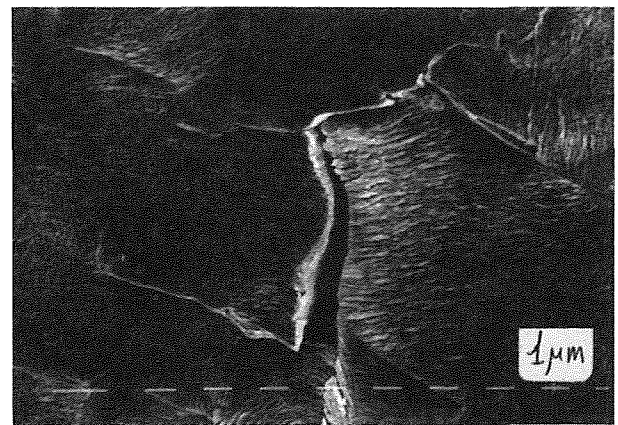
Fig. 10. Grieta intergranular generada a T = 180^\circ\text{C} , \epsilon_T = 7.0 \times 10^{-3} y \epsilon_T = 3.3 \times 10^{-3} \text{ s}^{-1}
