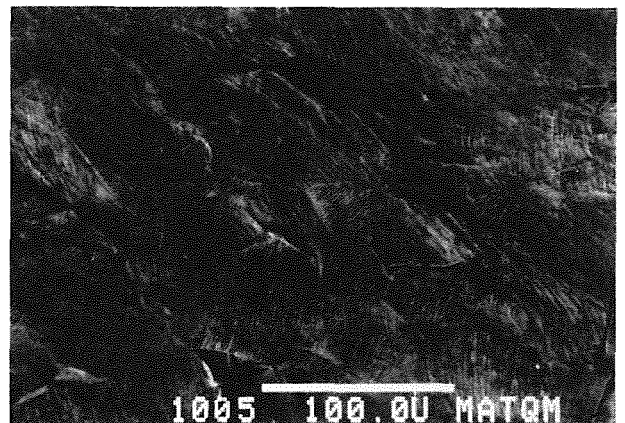
Fig. 6. Aspecto de la superficie de una probeta fatigada a \epsilon_T=7 \times 10^{-3} , \epsilon_T=2.8 \times 10^{-3} \text{ s}^{-1} y T=21^{\circ}\text{C} .
