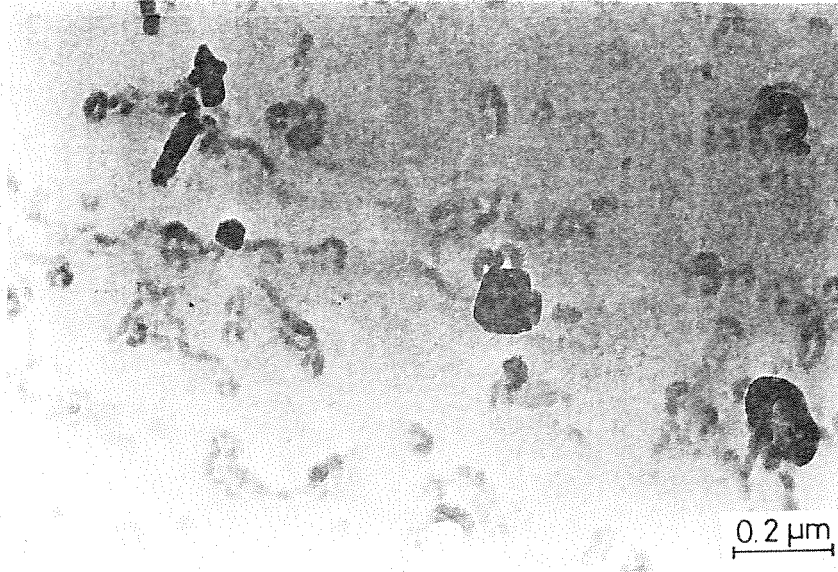
Fig. 9 - Precipitados de AlN en una probeta de alta ductilidad ( \bar{\epsilon}_f = 17 ), ensayada a 1000°C (calentamiento previo a 1200°C) y \dot{\epsilon} = 1,6 \cdot 10^{-1} \text{ s}^{-1} .
