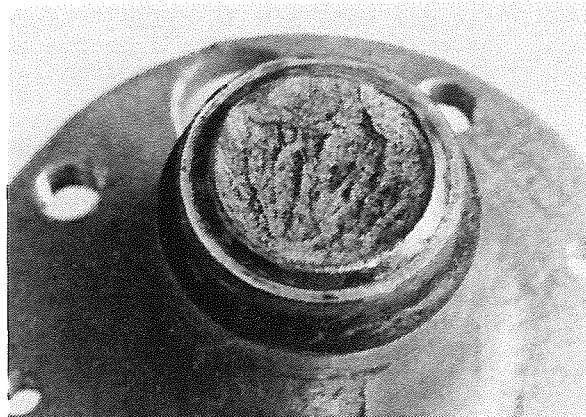
Fig. 2. Aspecto de la superficie de rotura (x 1).
