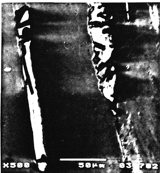
Foto 2. Detalle de escorias en hierro pudelado.
