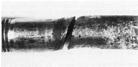
Fig. 8. Visión, a mayores aumentos, de la rotura del tornillo B. Se aprecian huellas de la actuación de tensiones de cizalladura y deformación plástica (x 1'5).
