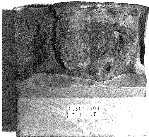
Fig.3a. Frente heterogéneo de grieta a fatiga
