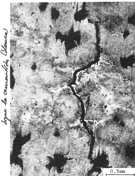
Fig. 6. Trayectoria de la grieta de fatiga (TT4)
