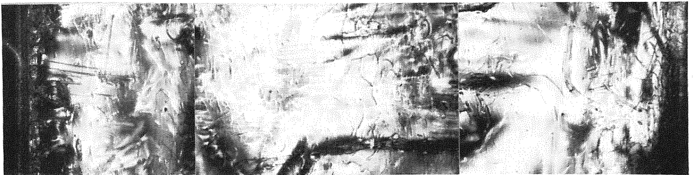
Fig. 10. Superficie de fractura observada por M.O. del material 2, a baja velocidad.
