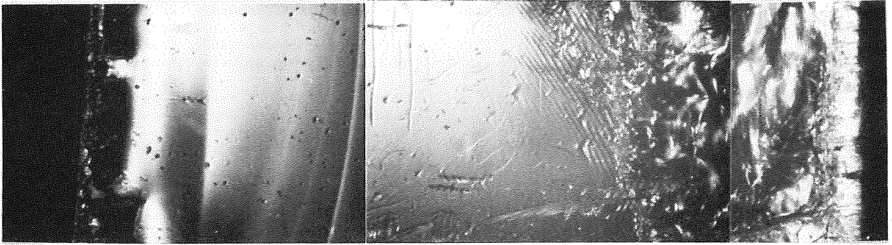
Fig. 8. Superficie de fractura observada por M.O. del material 1, a baja velocidad.
