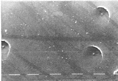
Fig. 9. Micrografía (MEB) de la zona de espejo del material 1.
