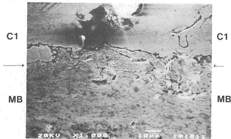
FOTO 11: Zona de discontinuidades en el límite de la primera capa y el material base en la superficie lateral de P1. (x1000)
