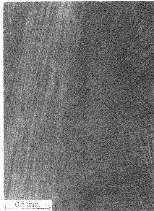
Figura 2. Aspecto del frente de entalla tras la aplicación de una carga igual al 70% P_Q (SMC 2)
