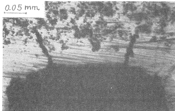
Fig.6a 450000 ciclos(300000 ciclos sin grieta).
