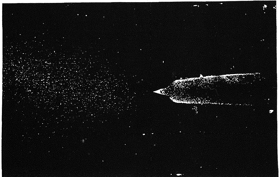
Autorradiografía de 40 días después de la carga catódica
