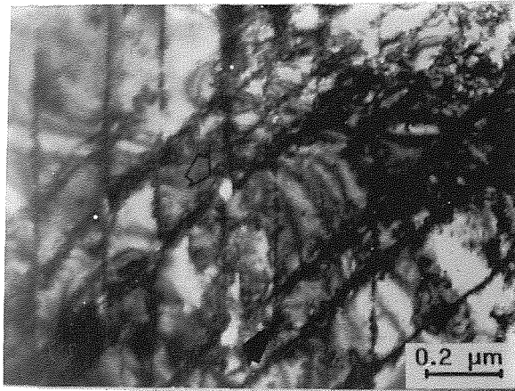
Fig. 9. Placa de cementita extraída del acero anterior tras deformación por alargamiento axisimétrico (trefilado), \epsilon = 0,43 . Nucleación de clivaje por intersección de dos bandas de deslizamiento. El plano de la placa es el (001)_C . Las trazas verticales son compatibles con deslizamiento sobre (010)_C y (011) y las inclinadas con el (110)_C . Reproducido de [34].
