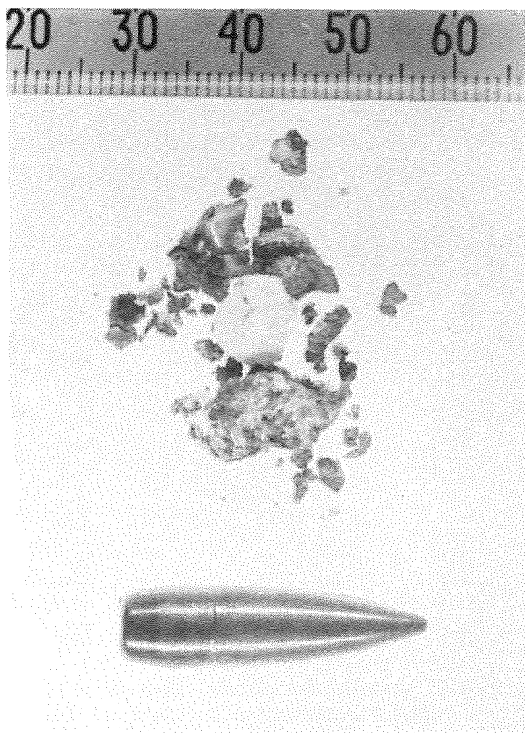
Figura 3. Aspecto de un proyectil 7.62 NATO antes y después del impacto.
