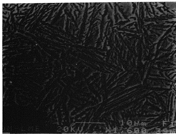
Fig. 1c. Tª de austempleado de 340 °C
